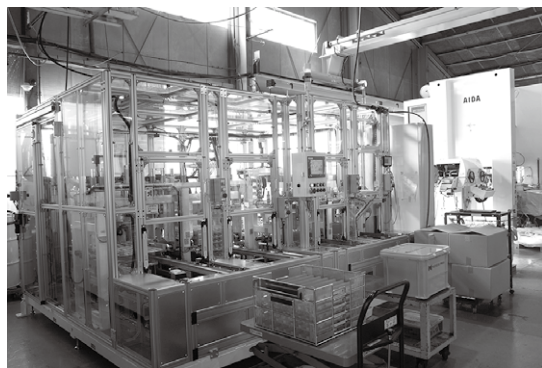
写真4 AI機能付き画像検査システムを組み込んだ自動化ライン。右手に見えるのがプレス機械
