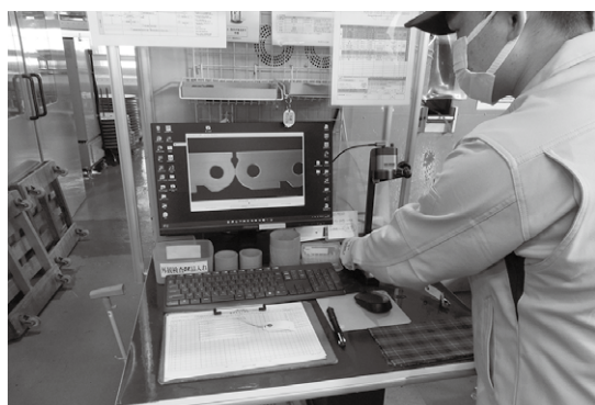
写真6 部品をカメラにかざし、回しながらチェック
